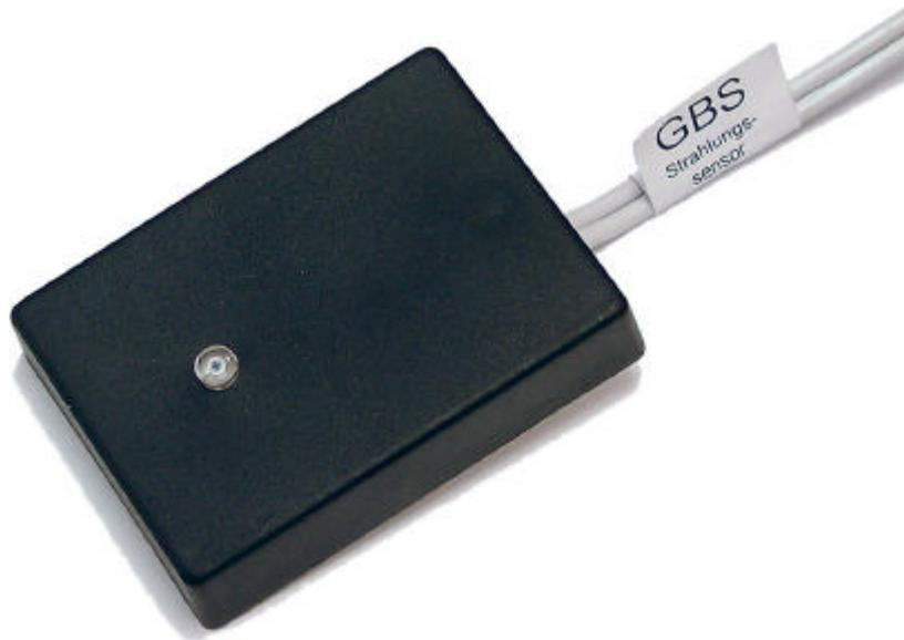
Der Strahlungssensor GBS01 wurde zur Erfassung der Solarstrahlung in Verbindung mit den UVR-Reglern entwickelt. Mit Hilfe dieses Sensors wird der Anlagenstart erleichtert bzw. ist ein exakteres „Hochschalten“ in den Vorrangverbraucher bei Mehrkreissolaranlagen möglich. Bei Verwendung zweier Sensoren lässt sich ein Kollektornachführungssystem aufbauen. Durch seine Genauigkeit kann er auch für reine Messzwecke eingesetzt werden.
